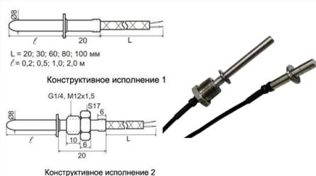
Коммутируемые: напряжение -  $\approx 24$ В,  $\approx 120$ В, Ток - 1А, Температура срабатывания: от -20 до 200°C через 10°C, Погрешность:  $\pm 5^\circ$ C, Гистерезис: 2°C, Нормально-замкнутые контакты (возможно изготовление с нормально-разомкнутыми контактами), Кол-во коммутационных циклов - не менее 50000, Максимальное давление в контролируемой среде - 1,6 МПа, При температуре размыкания контактов возможен небольшой дрейбз (несколько периодов замыкания-размыкания)
