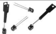
Релейная зависимость сопротивления от температуры. Metallостеклянный корпус (КТ1)  $d4,8 \times 5$  мм; Тср. 68°C с отклонением  $\pm 1^\circ$ C; гистерезис 3...7°C; сопротивление: при 20°C не менее 1МОм; при 55°C не менее 250 КОм; при 75°C не более 0,2 КОм
