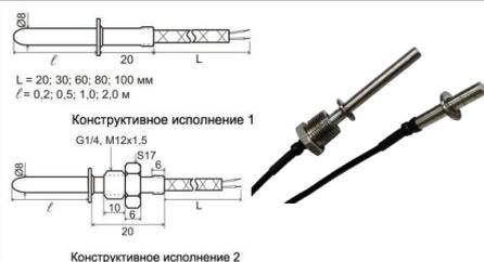
Коммутируемые: напряжение -  $\approx 24$ В,  $\approx 250$ В, Ток - 3А, Температура срабатывания: от 45 до 120°C с шагом 10°C, Погрешность: разброс по температуре срабатывания  $\pm 5^\circ$ C, Гистерезис: 25 $\pm$ 15°C, Нормально-замкнутые контакты, Кол-во коммутационных циклов - не менее 10000
